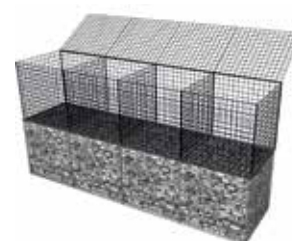
Relier une seconde rangée de gabions avec du fil de ligature
