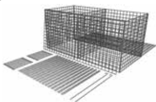
2 Ouverture du gabion
